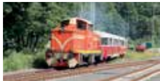
Lokomotiva se speciálním Abtovým ozubnicovým systémem, který je použit na ozubnicové trati z Tanvaldu do Harrachova. Foto: Aneta Rolníková.
